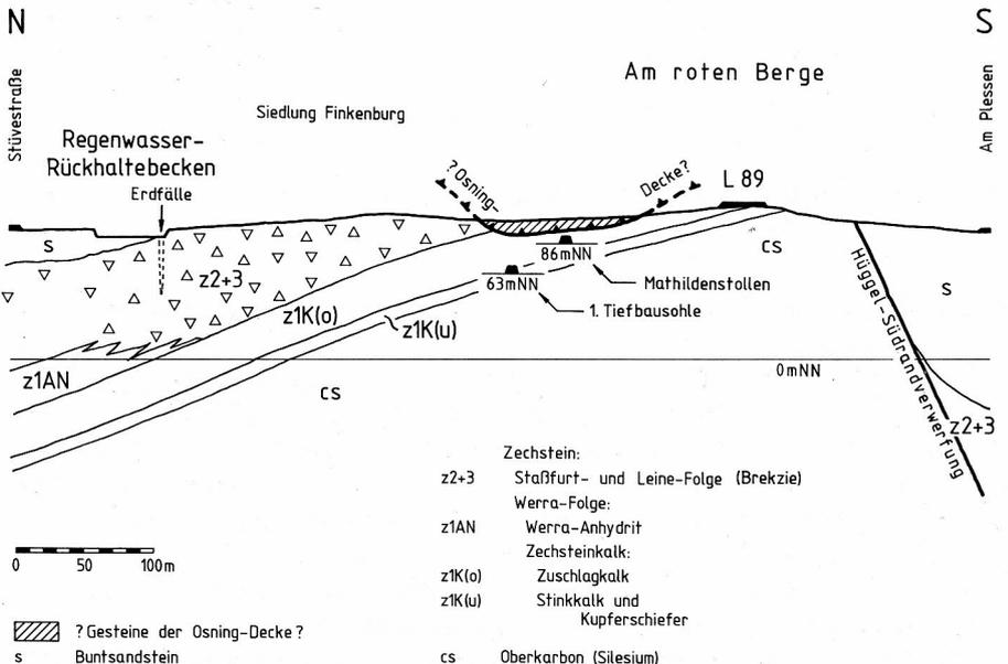
Abb. 3 Geologischer Schnitt durch das Regenrückhaltebecken am Roten Berg (Lage s. Abb. 1)
