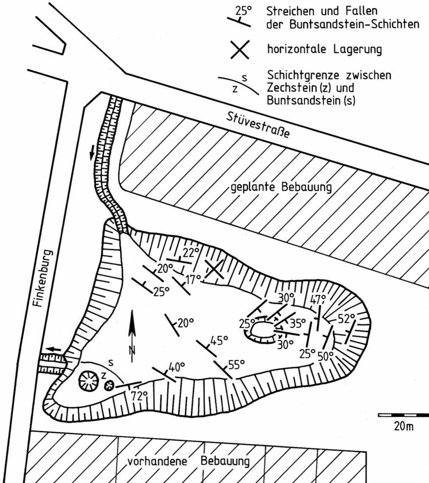
Abb. 2 Streichen und Fallen des Buntsandsteins im Regenrückhaltebecken am Roten Berg (Aufnahme: 2. April 1992)
