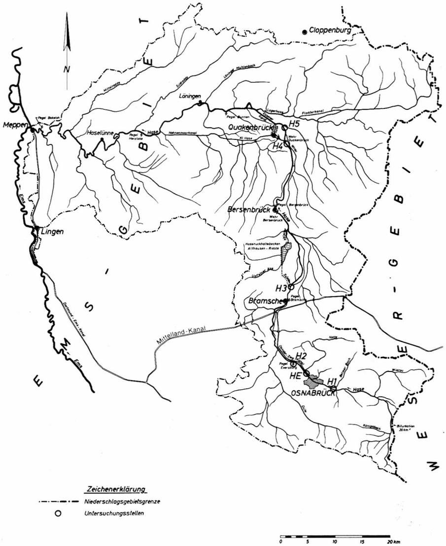
Die Hase und ihr Einzugsgebiet mit den Probe-Entnahmestellen
