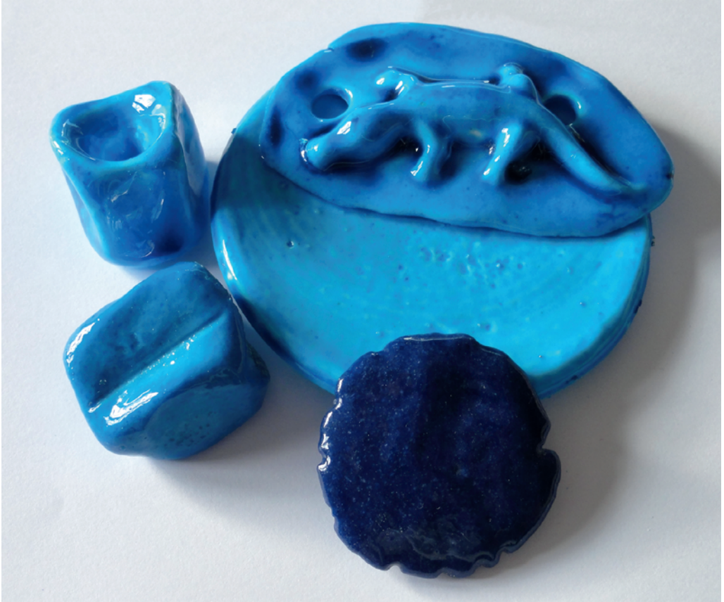
Abb. 5: Vier Objekte aus ägyptischer Fayence mit kupferhaltiger Anflugglasur sowie eines mit kobalthaltiger Applikationsglasur, Guido Sengle, Universität Kassel. Foto: Rainer Werthmann.
