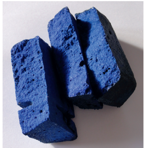
Abb. 3: Formkörper aus gesintertem Ägyptisch Blau, Guido Sengle, Universität Kassel. Foto: Rainer Werthmann.
