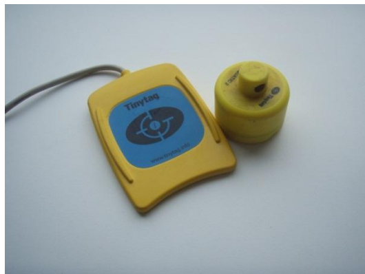
Abbildung 28: Zur Messung der Wassertemperatur verwendeter Datenlogger und Hardware zur Datenübertragung von der Firma Tinytag .
