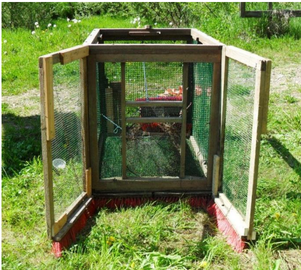
Abbildung 33: Kastenreuse (120 x 80 cm) mit einer Maschenweite von 1 cm 2 zur Funktionsüberprüfung der Fischaufstiegshilfe Rain.
