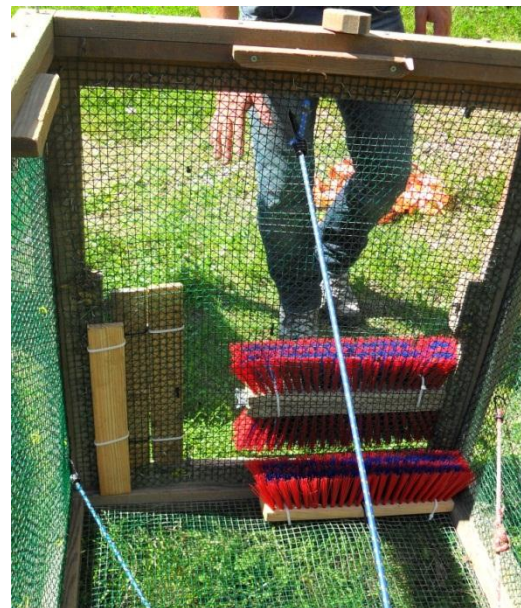
Abbildung 39: Strömungsschutz auf der Rückwand der Reuse.
