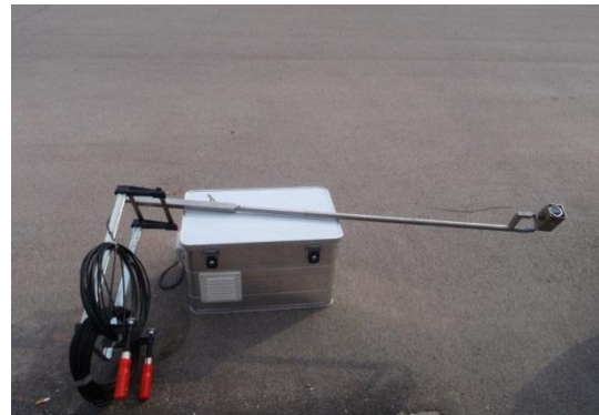
Abbildung 34: Videomonitoringsystem aus Kamera und Computer zur Datenspeicherung vor Ort (in der Schutzkiste).
