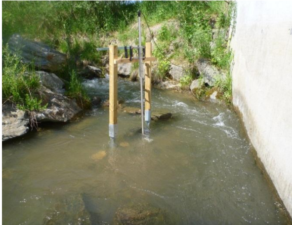
Abbildung 35: Videokamera zur Erfassung migrierender Fische im Einstiegsbecken der Fischaufstiegshilfe Rain.
