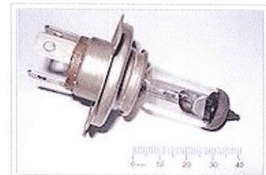
Bilux-Halogenglühlampe mit Glühwendeln für Fernlicht (Mitte) und Abblendlicht (rechts in der Blechblende)
