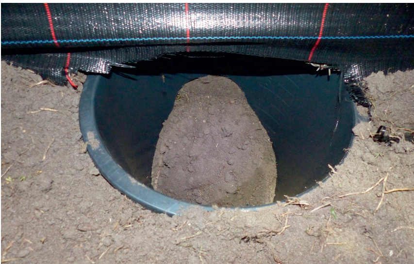
Abb.1: Verlust der Ventilfunktion auf Grund des Verschlusses des Ausstieges durch nachrutschendes Sediment (Foto: JÖRN KRÜTGEN).
