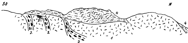
Fig. 19. Aufschlüsse nördlich vom Schwarzseeabfluß. 1. Heller, zerbrochener Dolomit; 2. Schwarzeckbreccie und grüne Schiefer; 3. dunkler Tonschiefer (Raibler?); 4. Altkristallin.
