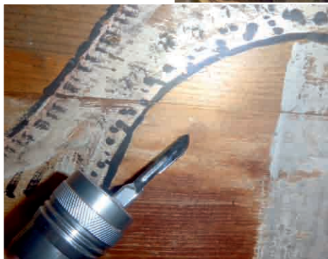
Abb. 19, 20: Bemalte Holztafeldecke (12. Jhd.) mit Befall durch Eurotium sp. und Aspergillus sp. (Zillis, Schweiz) (Foto: Sterflinger).
