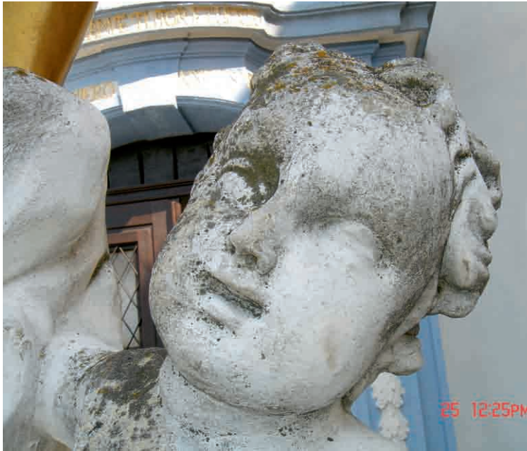
Abb. 1: Kopf einer geschlammten Natursteinfigur (Dürnstein, Wachau) mit Besiedlung durch Flechten, Cyanobakterien und schwarze Pilze (Foto: Sterflinger).
