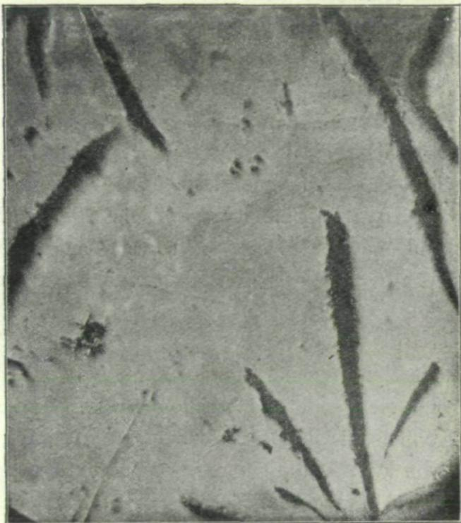
Fig. 1. Graues Roheisen, poliert, nicht geätzt,  $V = 400$  (Graphit).
