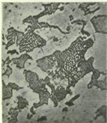
Fig. 4. Geschmiedetes Eisen ( $0.45\%$  C)  $V=1000$  (Ferrit und Perlit).
