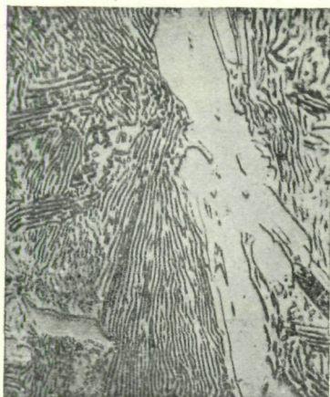
Fig. 11. Zementit (die hellen Teile) in Perlit. (Osmond.)
