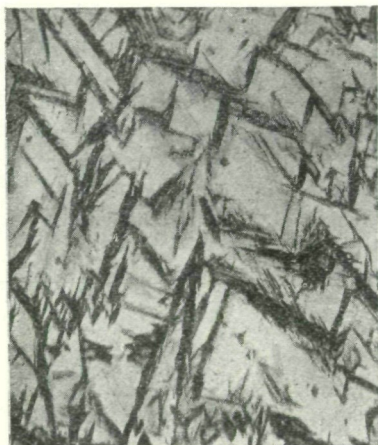
Fig. 13. Austenit (hell) und Martensit (dunkel) in 150-facher linearer Vergrößerung. (Osmond.)
