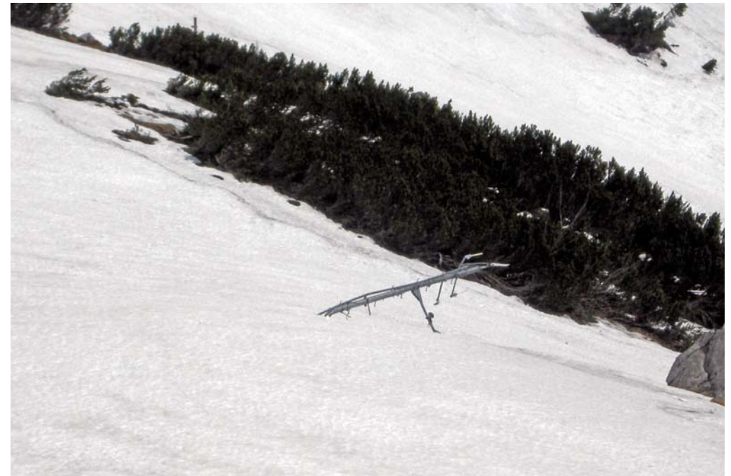
Abb. 12 | Der am 24.02.2009 durch eine Lawine zerstörte Schneepegel am Tamischbachturm | Foto: R. Tramberger
