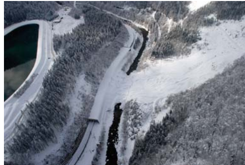
Abb. 14 | Lawine am 24.02.2009 über die Enns und Bahn/Straßengalerie zum Waagboden | Fotos: A. Podesser
