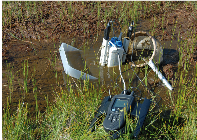
Abb. 1 | Durchfluss-Messgefäß mit E-Pumpe zur Erzielung gleichartiger Feldmess-Ergebnisse. Die gezeigte Probenstelle wäre ohne diese Ausrüstung kaum sinnvoll erfassbar. Probenstelle: Neuburgmoor NEUMO | Foto: C. Meisch, 2007
