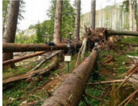
Abb. 7: Mikroklimatische Station zur Messung von Einstrahlung, Luft- und Rindentemperatur (Foto: E. Blackwell)
