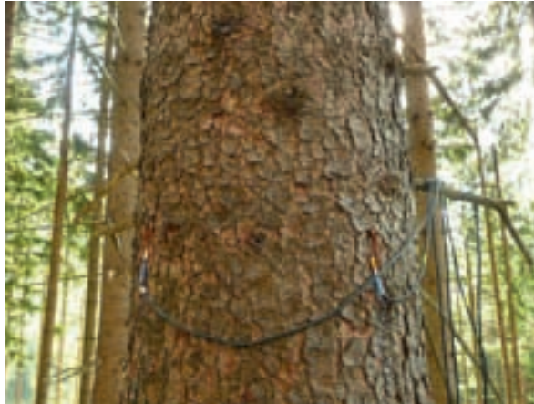
Abb. 6: Rindentempersensoren, den Himmelsrichtungen entsprechend zirkulär um den Stamm installiert (Foto: E. Blackwell)
