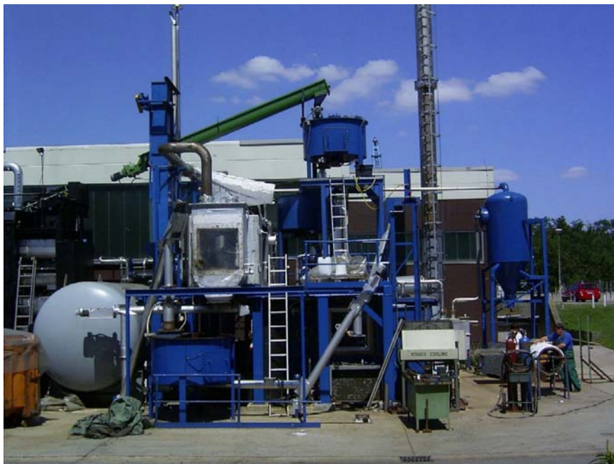
Abbildung 14: Frontansicht einer Hochtemperatur-Entgasungsanlage; (Quelle: Pyromex AG)
