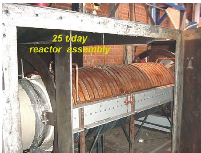
Abbildung 18: Reaktor mit Induktionsspirale; (Quelle: Pyromex AG)
