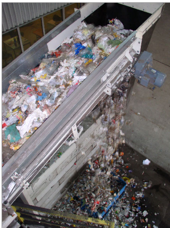
Abbildung 9: Beprobung der heizwertreichen Fraktion.
