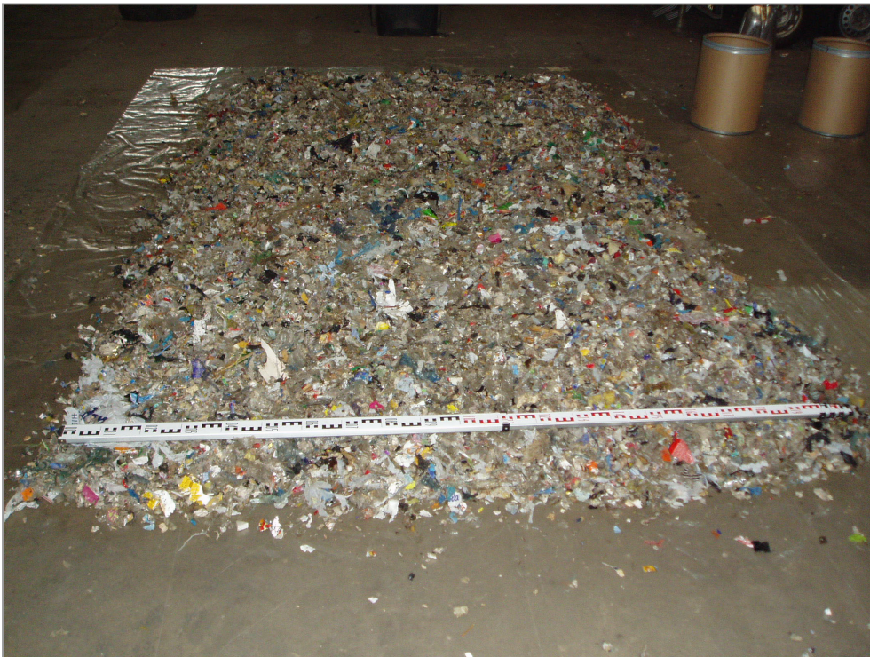
Abbildung 11: Flächige Aufschüttung zur Probenentteilung.
