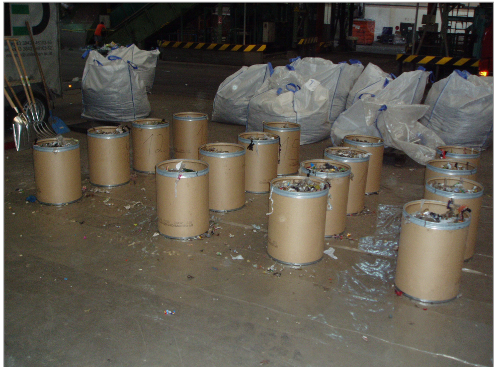
Abbildung 12: Probenteilung in 50 l-Tonnen.
