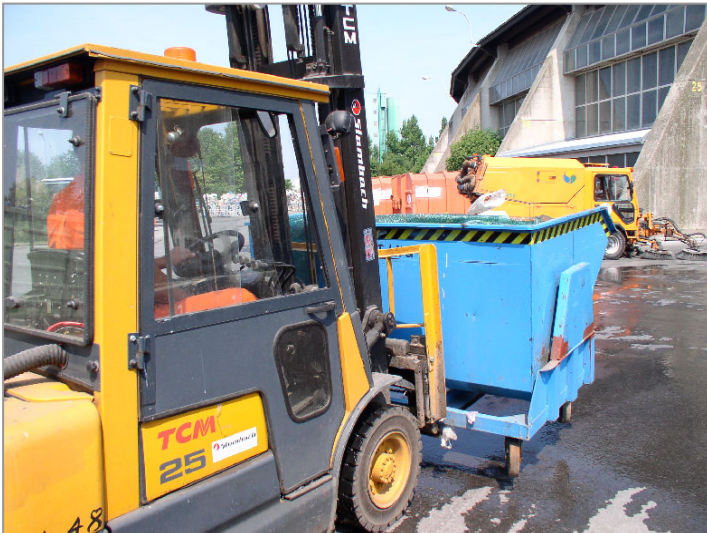
Abbildung 107: Transport des Rollcontainer (2 m 3 ) mittels Gabelstapler.
