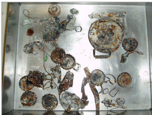
Fe-Fraktion: Weißblechdosen, Deckel, Schrauben; Inertanteil: Glas.
