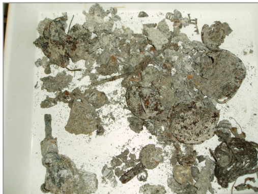
Abbildung 168: NFe/Fe-Fraktion zu Schlacke S0506 2432.
