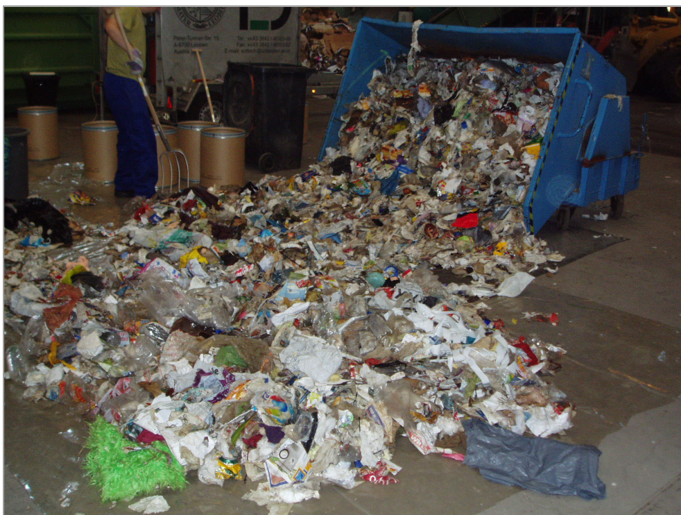
Abbildung 10: Erster Aufarbeitungsschritt – Aussortieren der Metallanteile und Steine.
