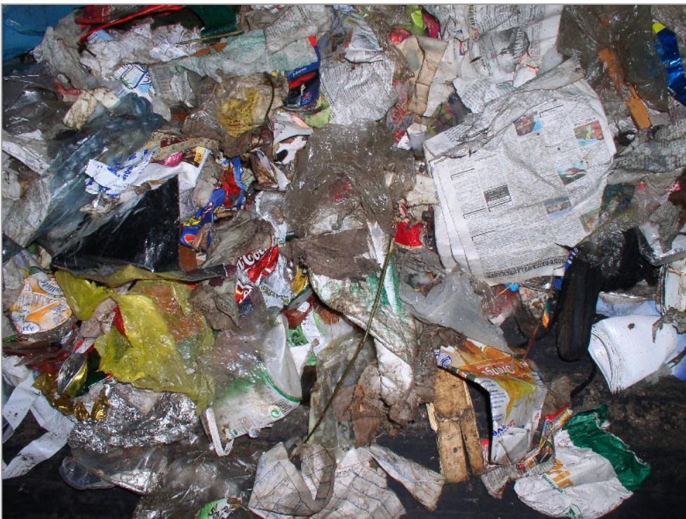
Abbildung 7: Heizwertreiche Fraktion 50–250 mm aus der Restmüll-Splittinganlage Wien, I.
