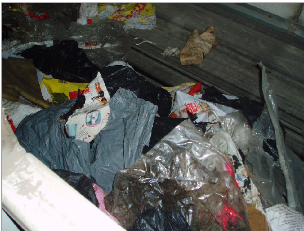
Abbildung 3: Siebüberlauf nach Trommelsieb > 250 mm.
