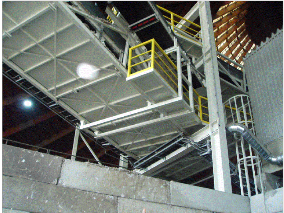
Abbildung 4: Zuführungsförderband (B810) und Schwenkband (B815).
