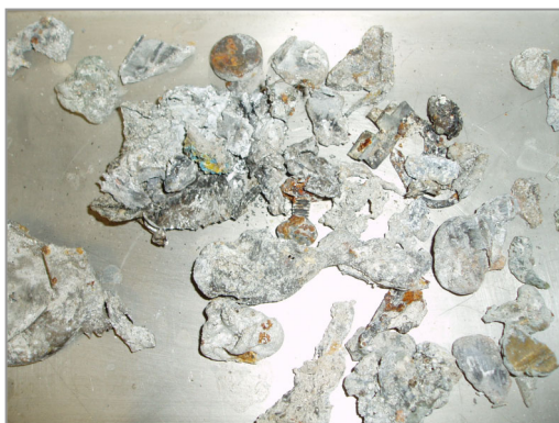
NFe-Fraktion: Zink, Aluminium, Silizium, Chlor und Kalzium.
