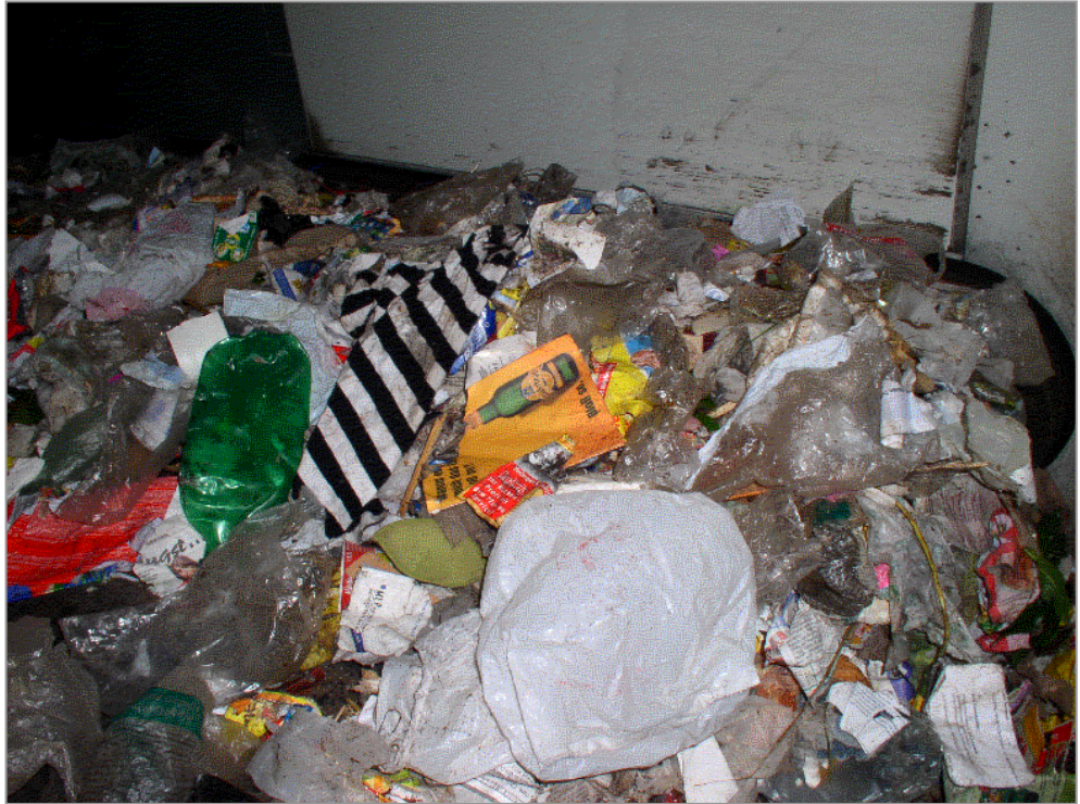
Abbildung 8: Heizwertreiche Fraktion 50–250 mm aus der Restmüll-Splittinganlage Wien, II.
