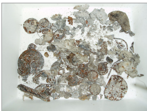
Abbildung 160: Fe, NFe zu Schlacke S0506 2411.
