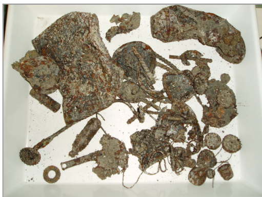
Abbildung 158: Fe-Anteil zu Schlacke S0506 2409.
