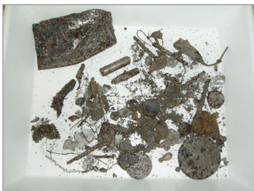
Abbildung 159: Fe, NFe zu Schlacke S0506 2410.
