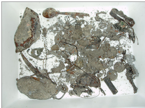
Abbildung 161: Fe, NFe zu Schlacke S0506 2412.
