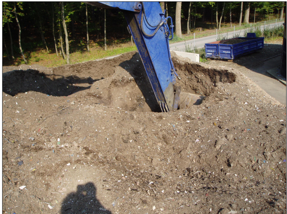
Abbildung 11: Probenahmebereich Wochenäquivalent Nr. 1 (Schürfe Bild links für Tagesäquivalent 1 und Bild Mitte für Tagesäquivalent 2 mit Löffelbagger).
