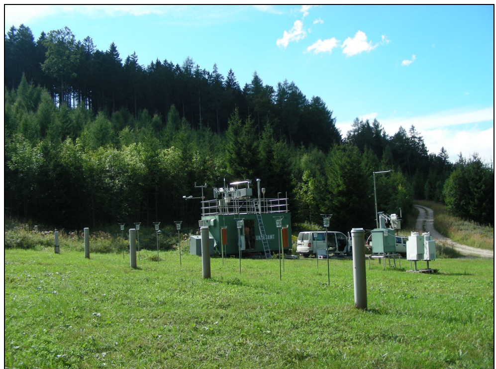
Abbildung 9: Messstelle Zöbelboden (Wildwiese) von Osten. Im Vordergrund stehen Niederschlags- und Staubniederschlagssammler, rechts WADOS. (© Umweltbundesamt, Rokop)
