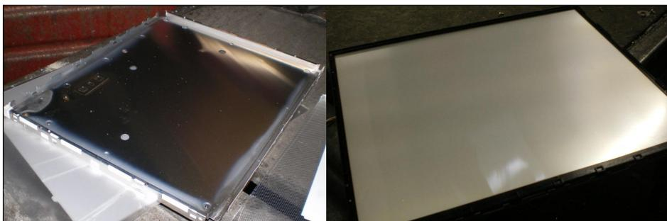
Abbildung 9: Rückwand und Rahmen eines LCD-Moduls (Quelle: Umweltbundesamt).
