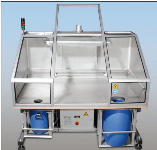
Abbildung 15: Demontagetisch der Fa. UNTHA (Quelle: [http://www.untha-recyclingtechnik.de/Eigene\\_Dateien/sonstiges/prospekt\\_lcd-d.pdf](http://www.untha-recyclingtechnik.de/Eigene_Dateien/sonstiges/prospekt_lcd-d.pdf)).
