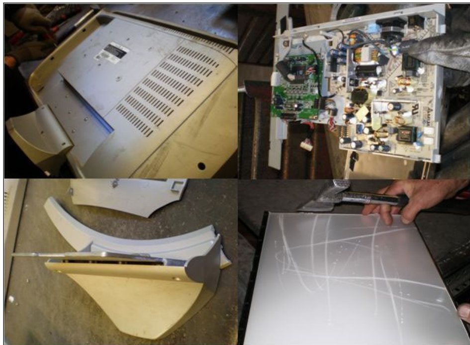
Abbildung 1: Gehäuse, Platinen, Standfuß, Schutzscheibe (Quelle: Umweltbundesamt).
