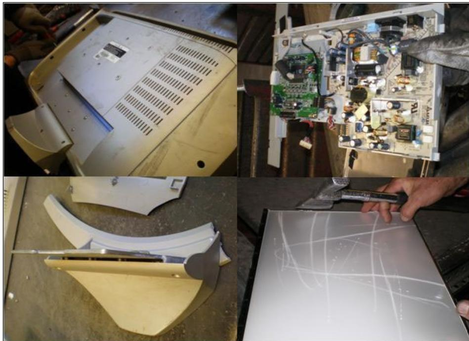
Abbildung 1: Gehäuse, Platinen, Standfuß, Schutzscheibe (Quelle: Umweltbundesamt).
