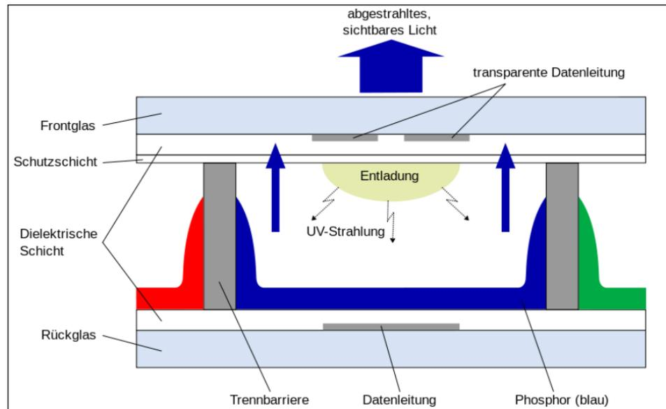
Abbildung 10: Funktion von Plasmaanzeigen (Quelle: Wikipedia, 2011)
