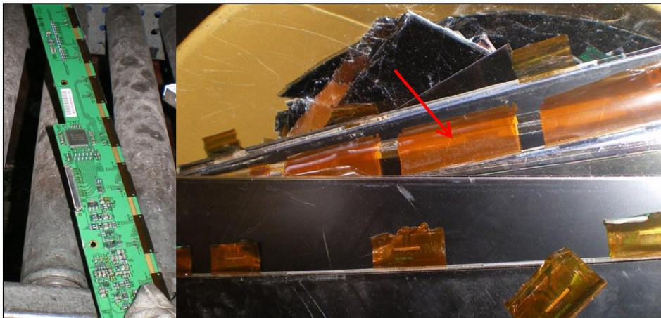
Abbildung 8: Leiterplatten und Ansteuerungselemente an den Displays (Quelle: Umweltbundesamt).
