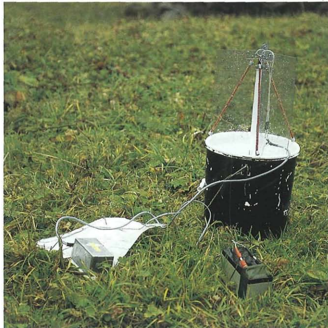
Abb. 4 + 5: Aggregatbetriebenen „Leuchtturm“ bzw. akkubetriebene Lichtfalle zur Erfassung nachtaktiver Schmetterlinge
