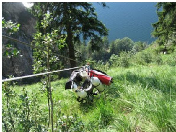
Ausrüstungstransport mit der neu eingerichteten Seilbahn
