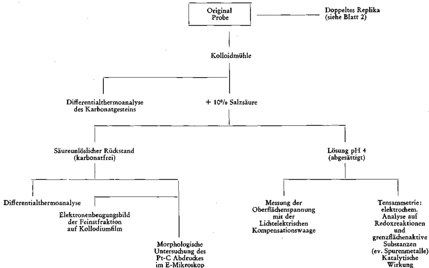
es mittels Differentialthermoanalyse untersucht. Weiters wurde eine morphologische Übersichtsaufnahme des Präparates angefertigt. Von diesem Präparat wurden mittels der Doppelreplikatechnik die elektronenmikroskopischen Bilder gewonnen (Abb. 1).
