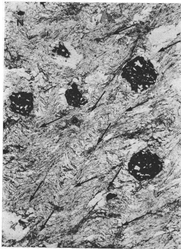
Abb. 4: Dünnschliffaufnahme eines Biotit-Flecken-Gneises mit 15facher Vergrößerung im Hellfeld. Deutlich sind zwei Schieferungen zu erkennen
