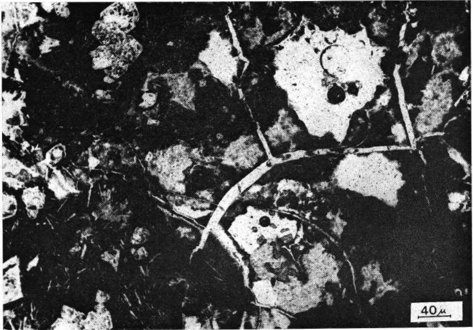
Abb. 3: Probe 2: in der linken Bildhälfte Basalt mit Plagioklasleisten und idiomorphen Pyroxenporphyroblasten; rechts gefrittete Sedimentlage mit Schrumpfungsrissen
