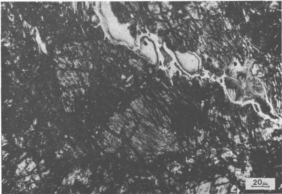
Abb. 6: Probe 7: s-partiell eingeregelt Hornblende mit teilweiser Umwandlung in Tonminerale, Klinozoisit und Eisenoxide; Nicols //
