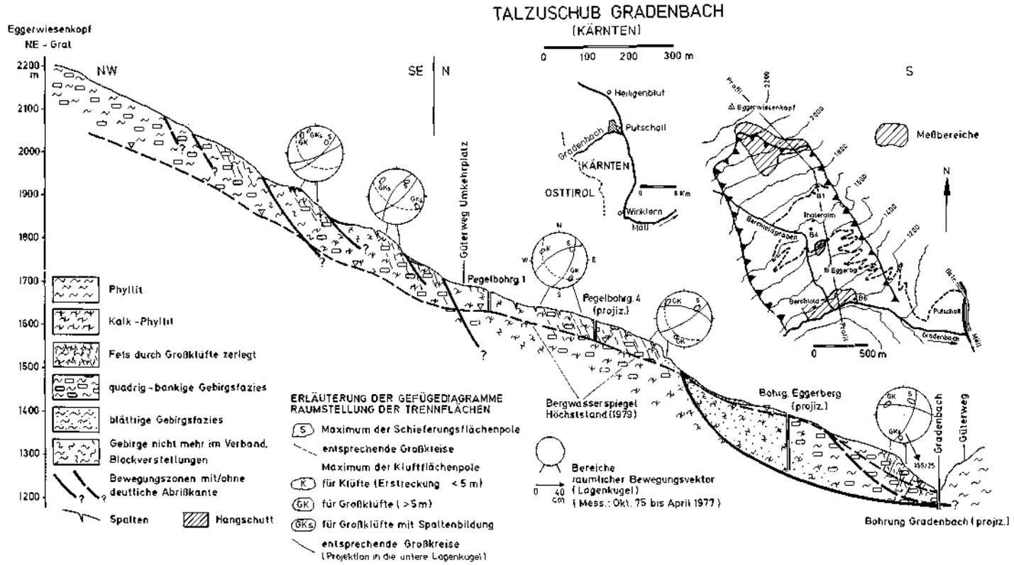
Abb. 3: Geotechnischer Längenschnitt über den Talzuschub Gradenbach.
