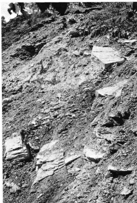
Abb. 18: Die in gewissen Bereichen sehr stark entfestigten und nur mehr als Lockergestein anzusprechenden Phyllite reagieren beim Instabilwerden mit Rotationsrutschungen.
