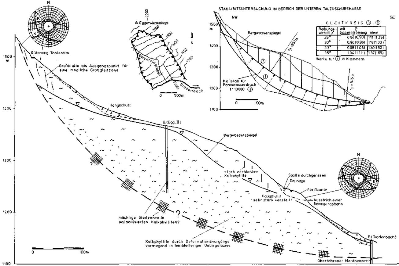
Abb. 19: Längsschnitt im Bereich der unteren Talzuschubmasse.
