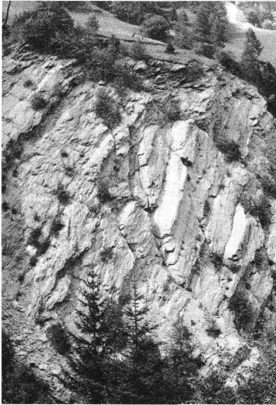
Abb. 15, 16: Quarzphyllite und untergeordnet Chloritphyllite in quaderig-bankiger Gebirgsfazies im mittleren Bereich der Talzusubsstirn. Als mechanisch wirksame Trennflächen sind deutlich die Schieferungsflächen 200-220/60-80^\circ und zwei Klufflächenscharen 100-140/80-60^\circ und 10-40/60-80^\circ ausgeprägt. Letztgenannte sind als Scherklüfte anzusprechen und können teilweise über 20 m durchhalten. Die geodätisch gemessene Verschiebungsrichtung in diesem Bereich (ca. 150/25^\circ ) steht in etwa senkrecht auf den Klüften 100-140/80-60^\circ .
