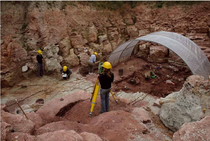
Abb. 2 Vermessung der Schicht 4-Oberfläche mit Tachymeter.
