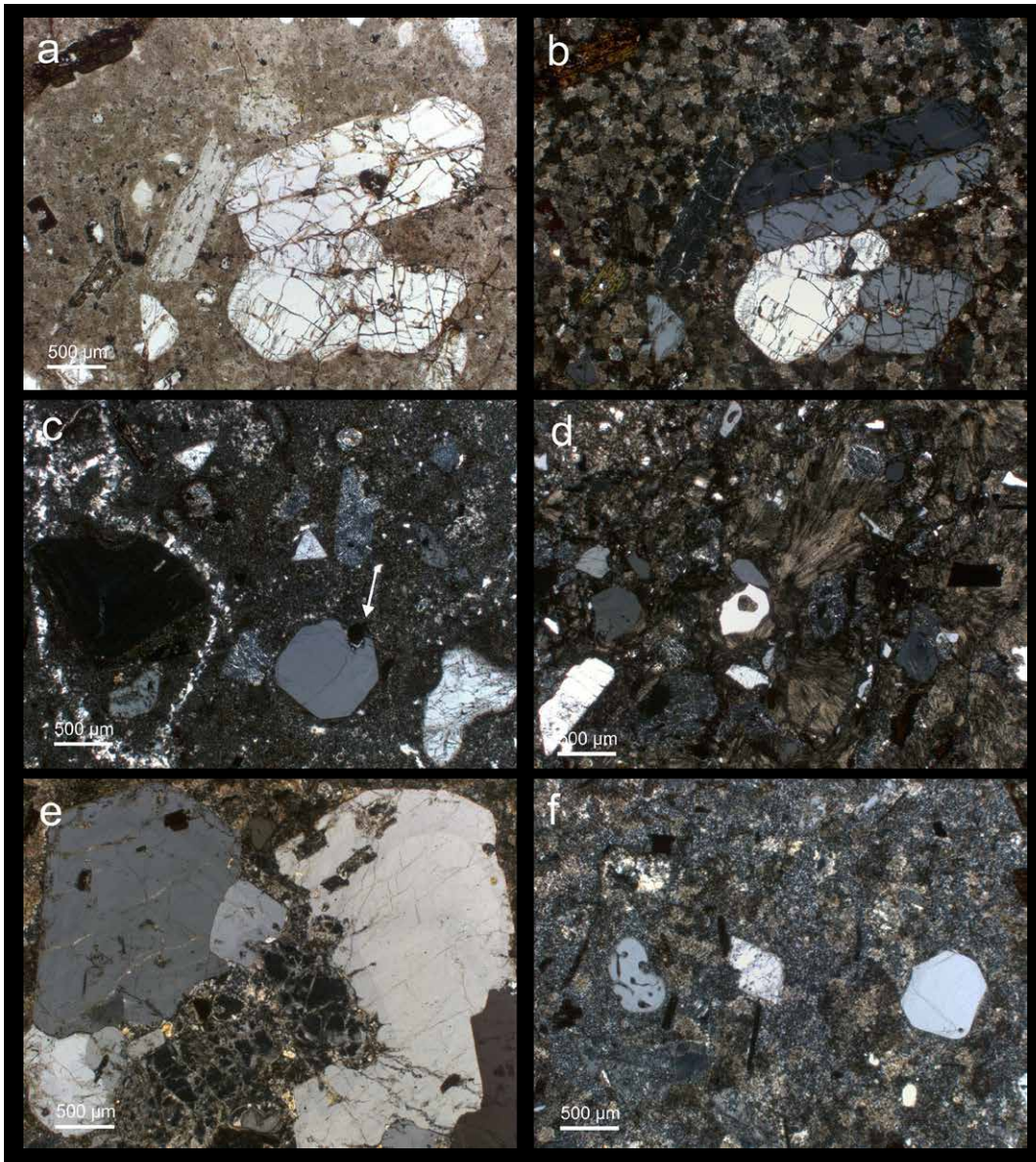
Abb. 6 Mikrofotos des Leisniger Porphyrs ; a/b – Leisniger Porphyr von Lauscha (4La – a – parallele, b – gekreuzte Polarisatoren) mit parkettierter Matrix, Biotit und Agglomerat aus brekziierten Kalifeldspäten (Sanidin-Zwillinge); c – Probe Wendishain (6Wen – gekreuzte Polarisatoren) mit feinkristalliner, silifizierter Matrix und Phänokristen von idiomorphem Quarz mit Wachstumsbehinderung durch Biotit (Pfeil), brekziierten Kalifeldspäten und alteriertem Biotit (opazitiert); d – Leisniger Porphyr von Podelwitz (11Po – gekreuzte Polarisatoren) mit sphärolitischer Matrix und Phänokristen von Quarz, Kalifeldspat, Biotit und alteriertem Plagioklas; e/f – Probe Queckhain (15Que – gekreuzte Polarisatoren); großes Agglomerat (Synneusis?) von Feldspat, Biotit und Quarz ( e ) sowie Quarz-Phänokristen in idiomorpher Ausbildung und mit deutlicher Resorption ( f ).
