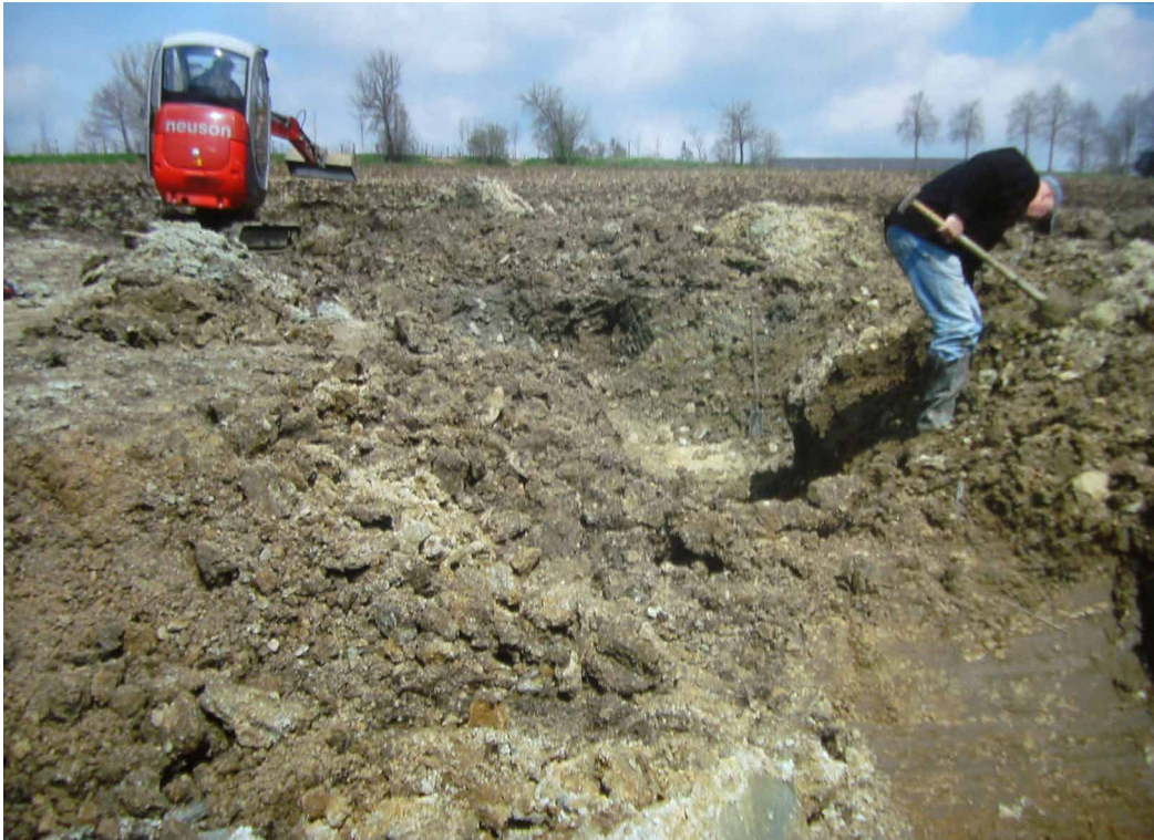
Abb. 11 | Schurf Liebgens Mühle 2012 Ca. 15x3 Meter, 2,5 Meter tief
