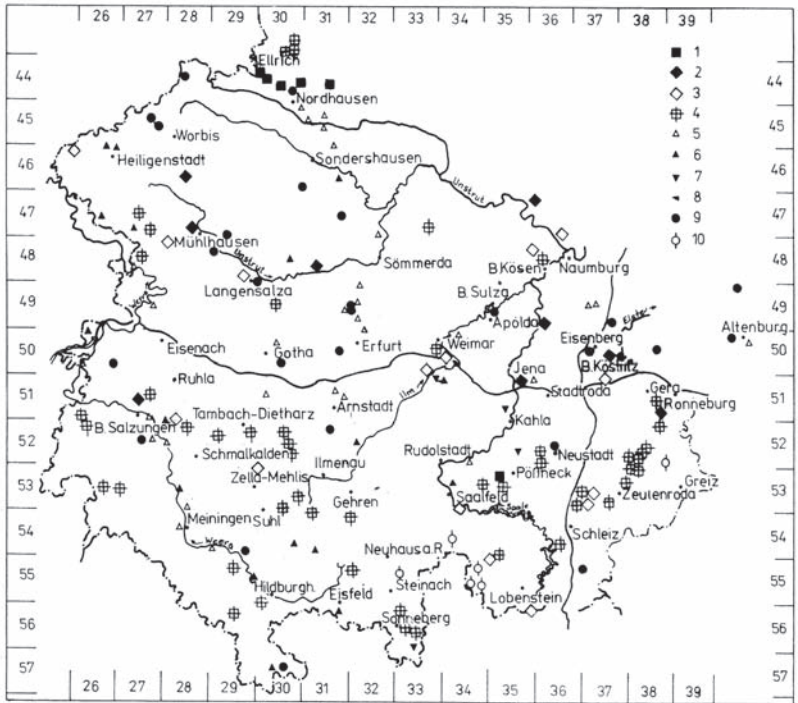
Abb. 1: Lageplan der Abbaustellen bzw. Betriebe mit Abbaustellen der Steine und Erden Thüringen um 1989. 1 – Anhydrit, Gips 2 – Zement, Kalk, Dolomit 3 – Werkstein 4 – Brecherprodukte 5 – Kies, Kiessand 6 – Sand für Bauwesen 7 – Feldspatsand 8 – Formsand 9 – Grobkeramik 10 – Schiefer
