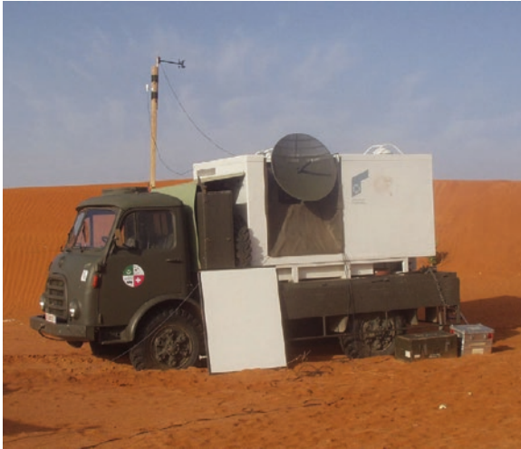
Abb. 13: Mobiler Radar in der mauretanischen Sahara, auf der Stange darüber ein automatischer Windmesser. – Mobile Radar in the Mauritanian Sahara, on the pole above an automatic anemometer.
