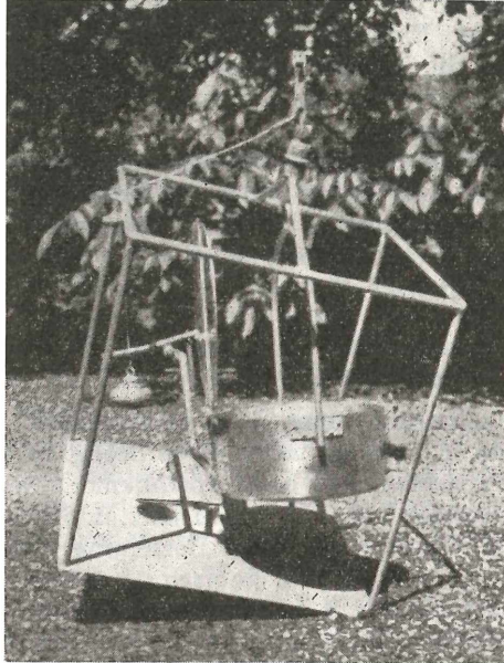
Abb. 1 Sedimentmeßpfanne geöffnet, auf unebenem Boden, wie sie im See aufgestellt wird.
