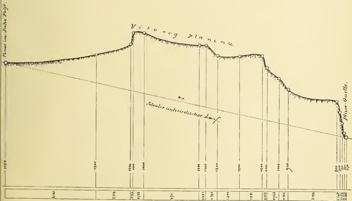
Fig. 2. Profil des Mrtvicabaches im Falle seines Ablaufes zur Pliva. (Vgl. S. 677.)
