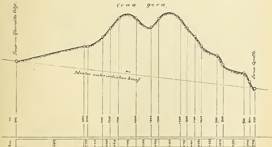
Fig. 2. Profil des Ribnikbaches im Falle seines Abflusses zur Sana. (Vgl. S. 675.)
