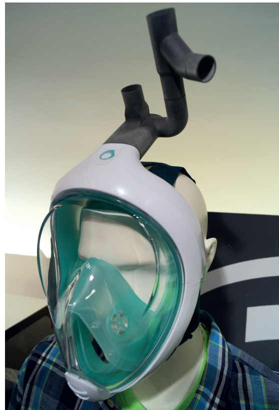
Abb. 5: Beatmungsmaske für schwer an Corona erkrankte Personen, entwickelt vom Campus Lienz der UMIT Tirol
