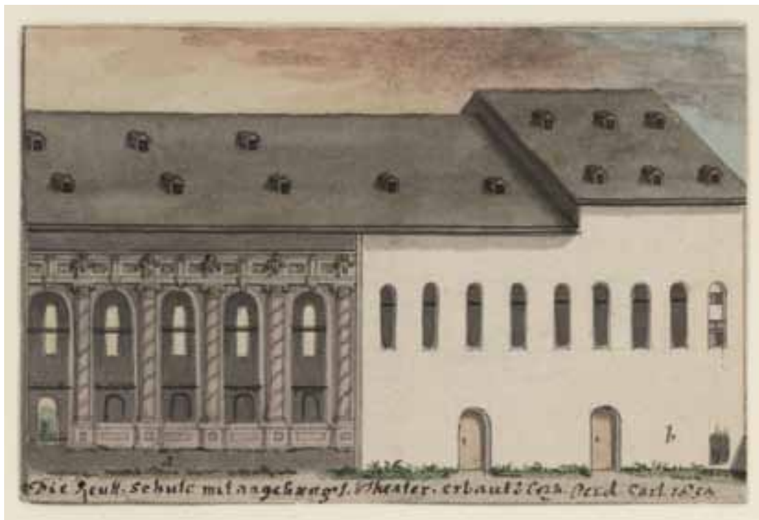
Abb. 12: Teil-Längsschnitt durch die Reitschule mit anschließender Fassade des Alten Hoftheaters. Aquarellierte Federzeichnung von Joseph Strickner, um 1800. Innsbruck, TLMF, Bibliothek, FB 1673/14.
