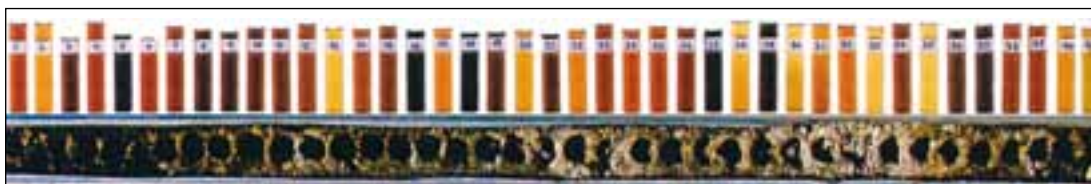
Abb. 14: Sedimentprofil aus dem Uferbereich des Stappitzer Sees von -71 cm Tiefe (links) bis 0 cm (rechts) und den zugeordneten alkalischen Huminstofflösungen von Probe 1 (links) bis Probe 41 (rechts).
