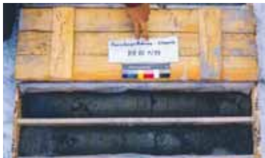
Abb. 4: Bohrkern aus der Bohrung STA-5 (Stappit-5), Meter 138–148: Typisches Grundmoränenmaterial, der Kiesanteil ist auf den ersten Blick kaum zu erkennen. Foto: F. H. Uciik, 18.11.1999.
