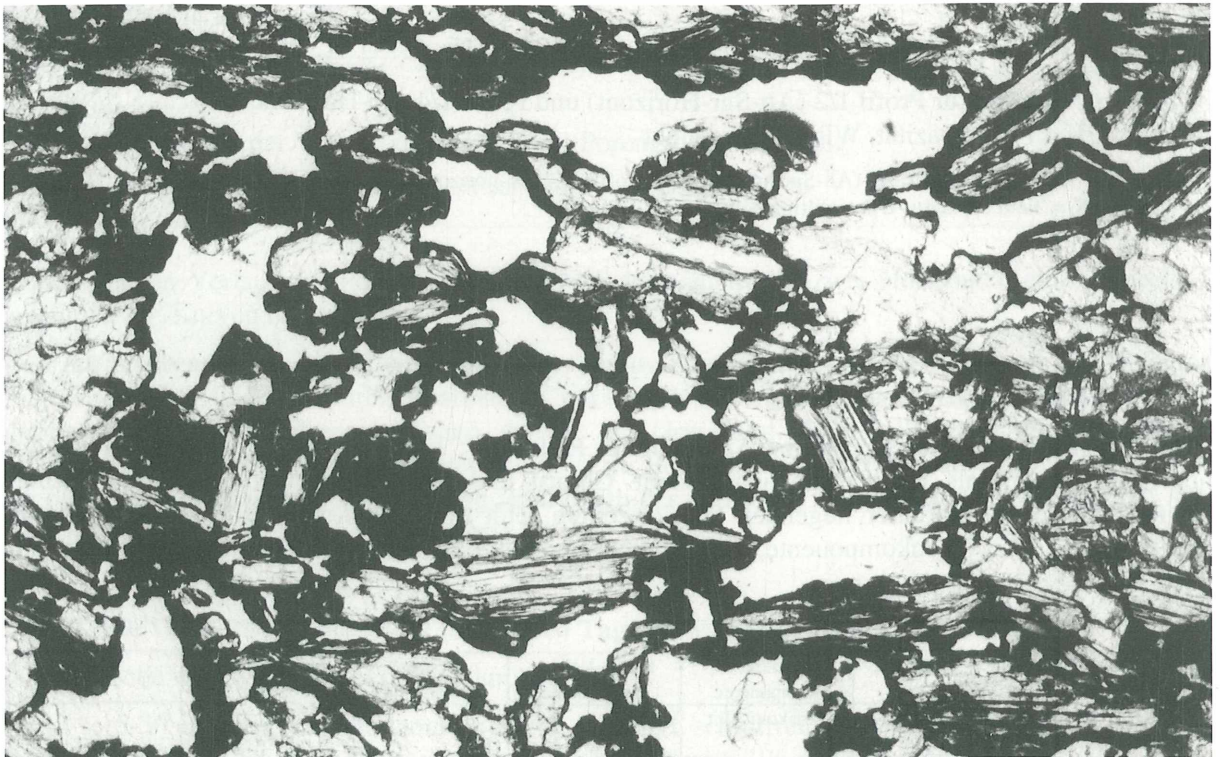
Abb. 5: Profil 1, 3-15 cm Tiefe: Kompakte Mikrostruktur mit einigen Röhren und Kavernen, Teilchen durch Eisen(?) -Humus-Ummantelung zusammengekittet; 40fache Vergrößerung
