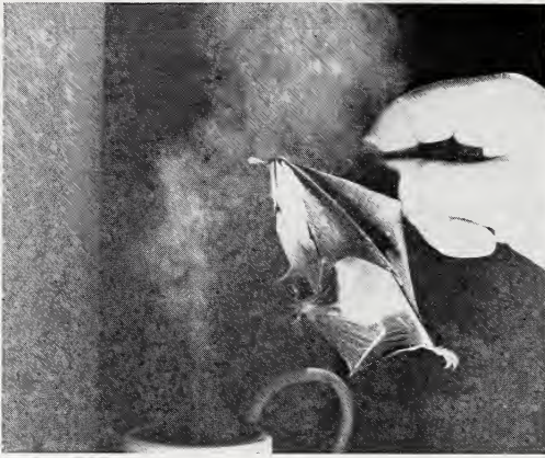
Abb. 8. Mit Rauch sichtbar gemachte Luftströmung beim Flügelschlag eines Mausohrs. Von links: Bretterwand, Raucherzeuger mit zuführendem Luftschlauch, Rauchfahne, Fledermaus am Genick gehalten mit gerade niedergeschlagenen Flügeln
