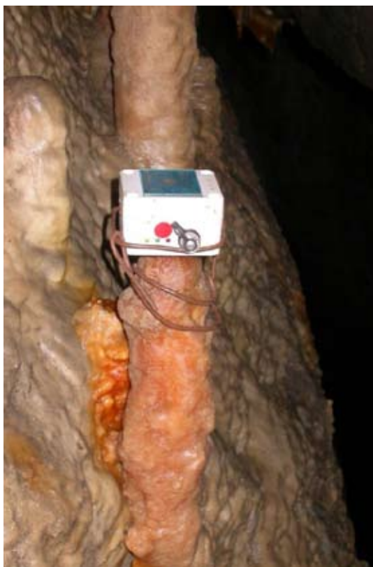
Dieses kleine Gerät misst die Tropfwassermenge im unterirdischen Labor.
