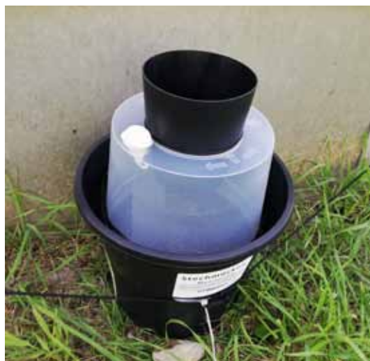
Adultfallen (Gravid Aedes Trap, GAT): locken mit Wasser (Heuabsud) und der dunklen Öffnung weibliche Aedes-Mücken zur Eiablage an. Das Mückenweibchen fliegt durch die Öffnung, kommt aber wegen eines Netzes nicht zum Wasser. Beim Versuch zu entkommen bleibt es an der angebrachten Klebefläche hängen. So können legebereite Weibchen angelockt und gesammelt bzw. bekämpft werden. (Foto: Klaus Zimmermann)
