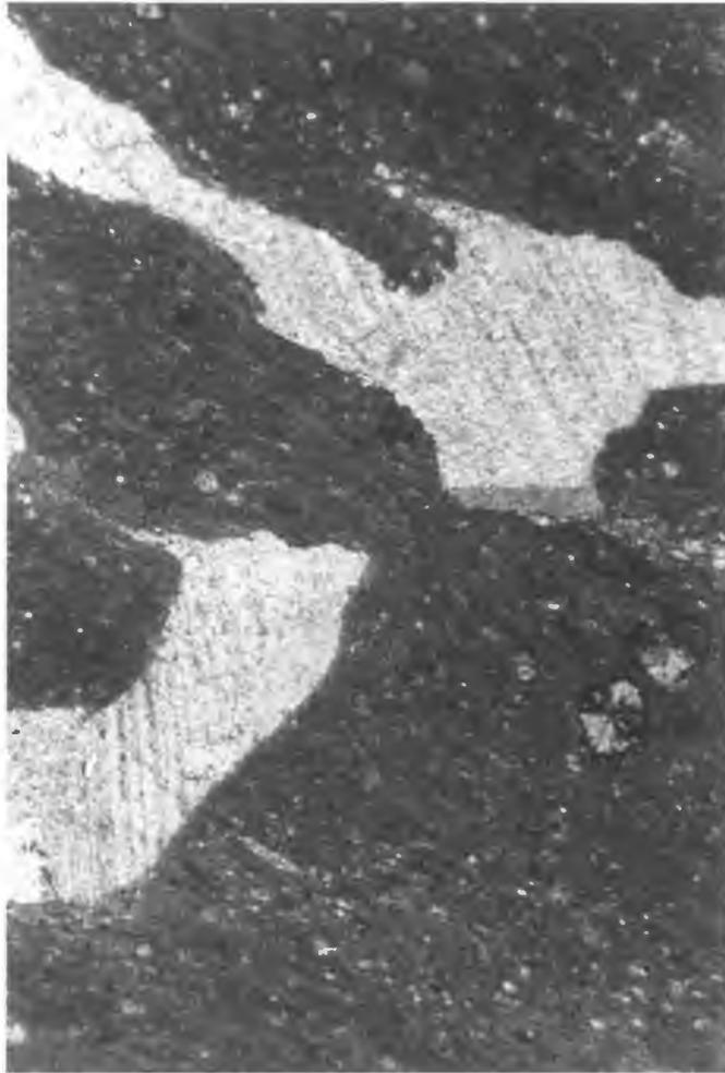
Abb. 6: LF-B-Gefüge mit Internsediment; Steinbruch Frettholz. Dünnschliff, Vergr. 30x.
