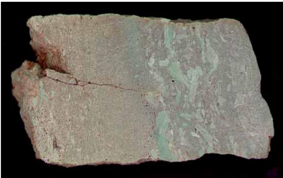
Abb. 15: Sandstein, quarzitisches, kalkfrei, mit grünlichen intraformationellen Schluffsteingeröllen (Anschliff); Haldenbereich des Steinbruchs Düstertal, R<sup>34</sup> 79080, H<sup>57</sup> 03 710, Blatt 4518 Madfeld)
