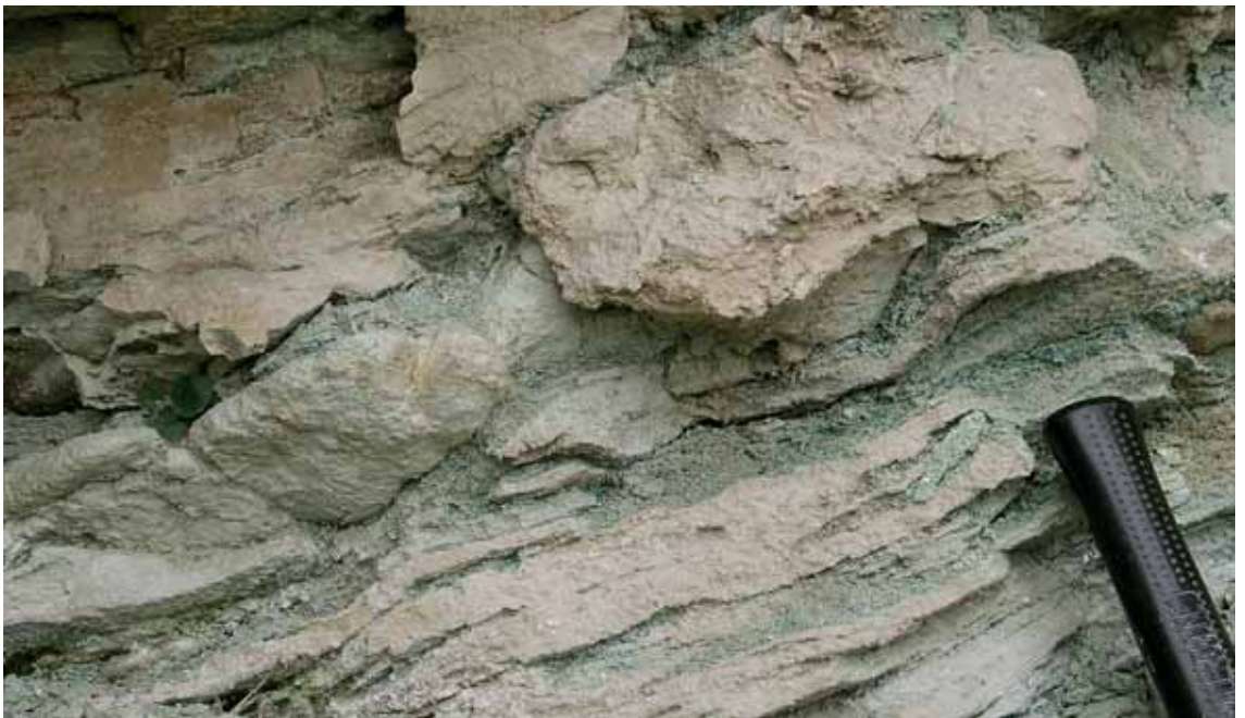
Abb. 5: Karbonatischer Feinsandstein mit Anreicherungen von Glaukonit und Fossilbruchstücken, Spalte A im Steinbruch Düstertal, R 34 79 200, H 57 03 650, Blatt 4518 Madfeld
