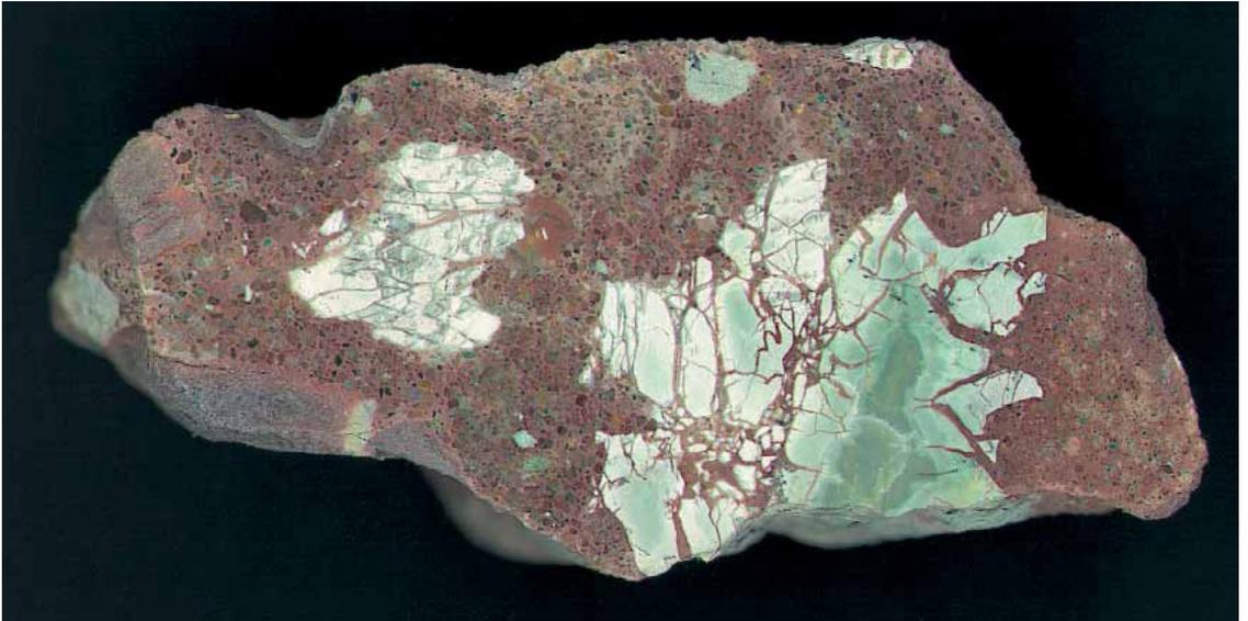
Abb. 18: In situ fragmentiertes Kieselgestein-Geröll in sandiger glaukonitischer Grundmasse (Anschliff), Baugrube Peuker in Bleiwäsche, R<sup>34</sup> 79 750, H<sup>57</sup> 03 960, Blatt 4518 Madfeld.
