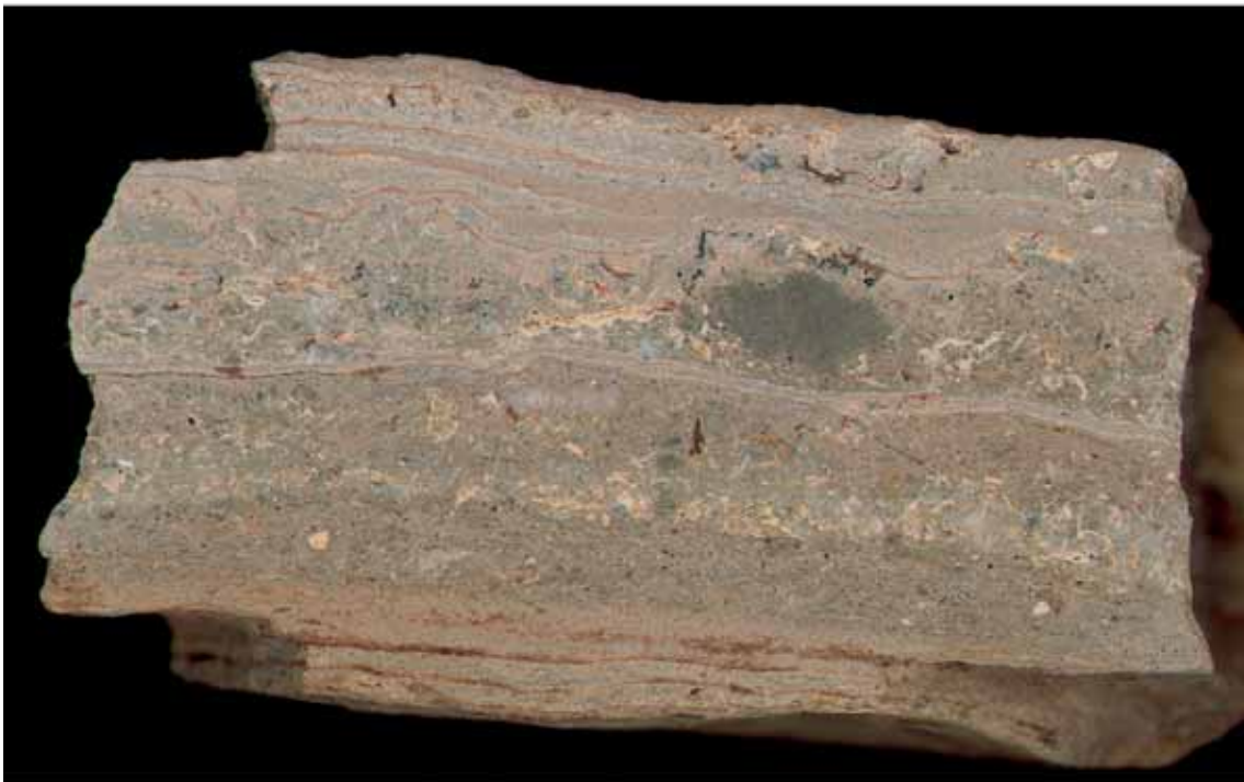
Abb. 11: Wechsellagerung aus unterschiedlich sandhaltigem Kalkstein mit Schlufflaminen; Sandfraktion aus Quarzkristallen unterschiedlicher Größe (Anschliff); Lesestein vom Spaltenbereich A und B.
