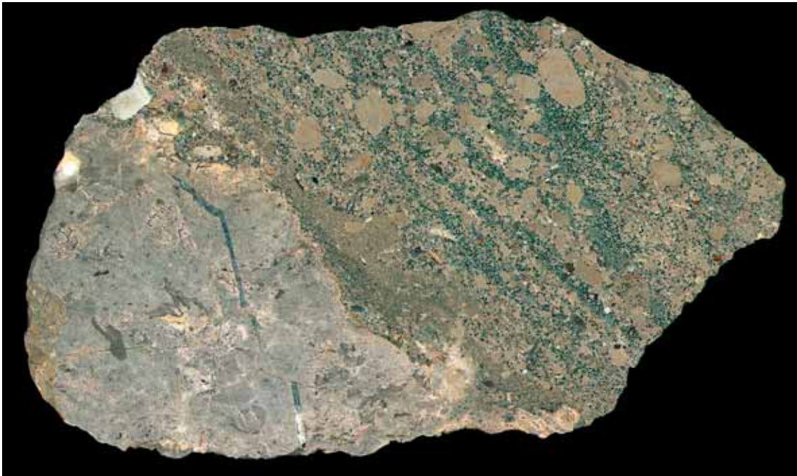
Abb. 14: Feinsandstein, kalkhaltig und glaukonitisch, angelagert an Massenkalk (Anschliff); Lesestein vom Haldenbereich des Steinbruchs Düstertal, R 34 79 080, H 57 03 710)
