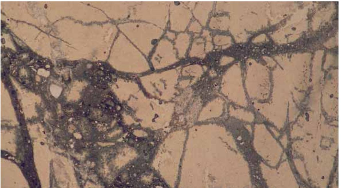
Abb. 8: Toniger Hornstein mit bioklastischer Spaltenfüllung (Dünnschliff 1 a, 1 b, 2, vergrößert), Spalte A im Steinbruch Düstertal, R<sup>34</sup> 79 200, H<sup>57</sup> 03 650, Blatt 4518 Madfeld
