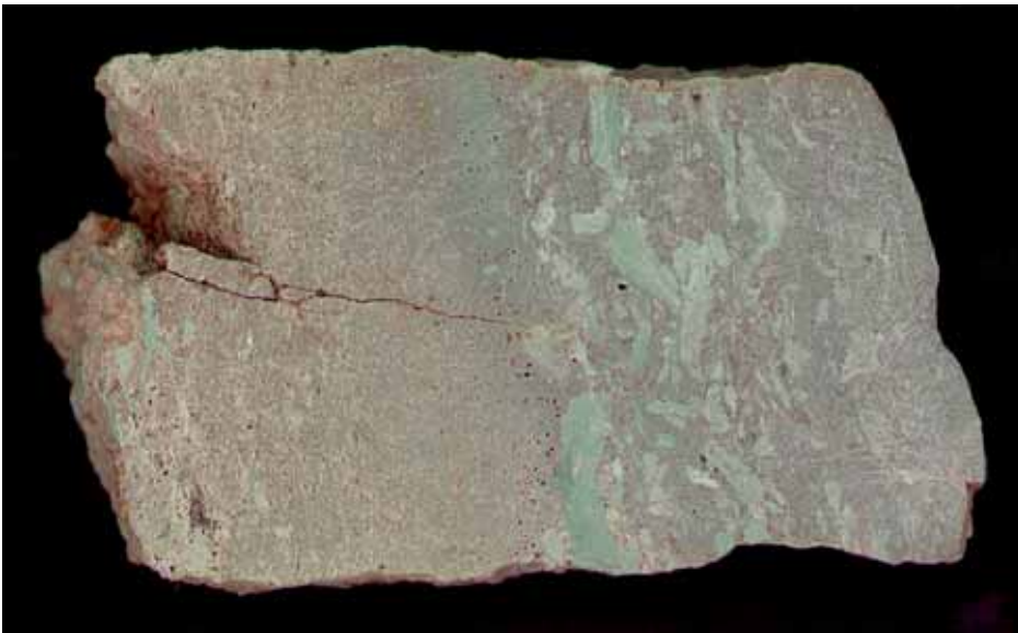
Abb. 15: Sandstein, quarzitisches, kalkfrei, mit grünlichen intraformationellen Schluffsteingeröllen (Anschliff); Haldenbereich des Steinbruchs Düstertal, R 34 79080, H 57 03 710, Blatt 4518 Madfeld)
