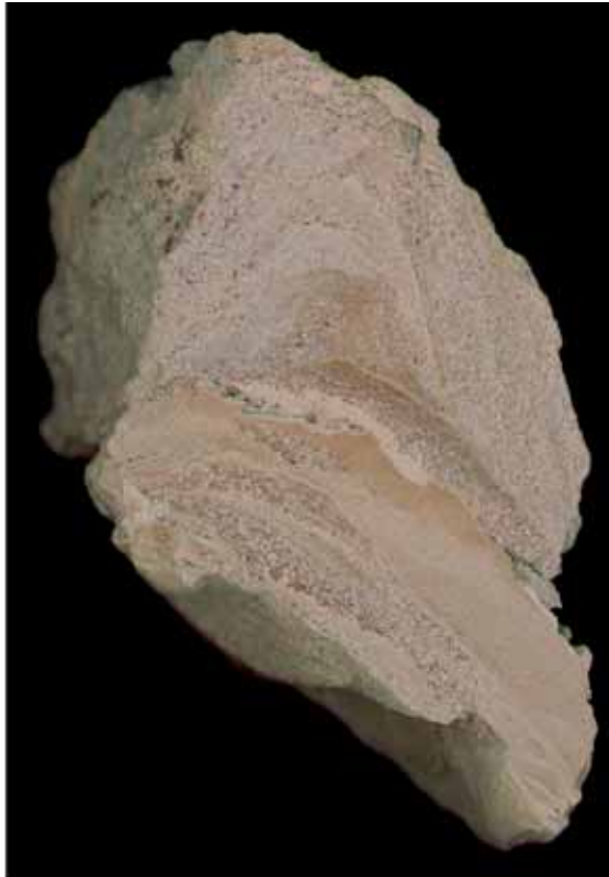
Abb. 12: Schwach kalkhaltiger Fein- und Grobsandstein, z. T. aus Quarzkristallen; die Schichten sind trichterförmig eigesenkt und diskordant überlagert; Lesestein vom Spaltenbereich A und B.
