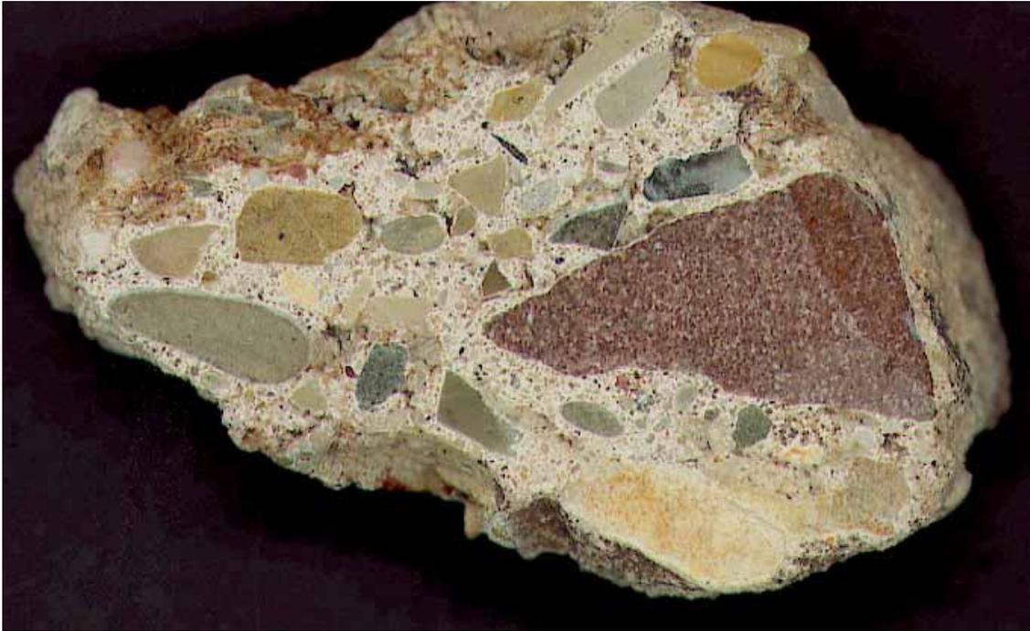
Abb. 17: Sandstein mit intraformationellen kreidezeitlichen und paläozoischen Geröllen; Baugrube Peucker in Bleiwäsche, R<sup>34</sup> 79 750, H<sup>57</sup> 03 960, Blatt 4518 Madfeld.
