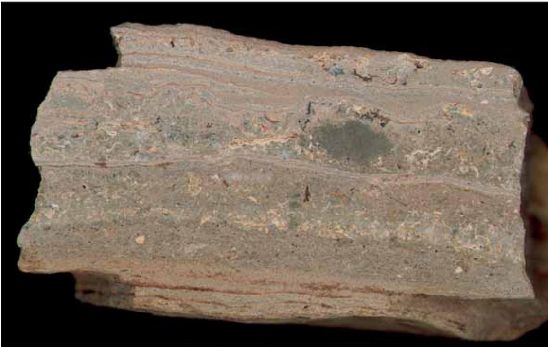
Abb. 11: Wechsellagerung aus unterschiedlich sandhaltigem Kalkstein mit Schlufflaminaen; Sandfraktion aus Quarzkristallen unterschiedlicher Größe (Anschliff); Lesestein vom Spaltenbereich A und B.
