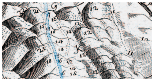
Abb. 8: Graphische Darstellung der geologischen Verhältnisse im Raum Königsee (K) – Gehren (G). Die Darstellung Füchsels entspricht annähernd den heutigen Erkenntnissen und zeugt von einer jahrelangen intensiven Kartierungsarbeit im Gelände. Beachtlich die Grenzziehung Zechsteinkonglomerat – Ordovizium (Verlauf entlang der Markierung 17) und die vermutete Störung in 14.
