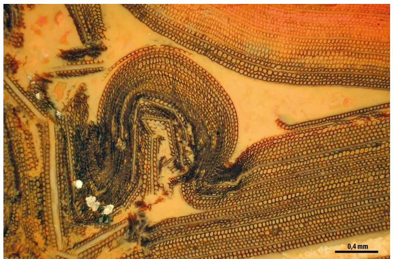
Abbildung 5. Holzspan in plastisch verformtem Kiefernholz. – Foto: R. NOLL, Geologische AG.
