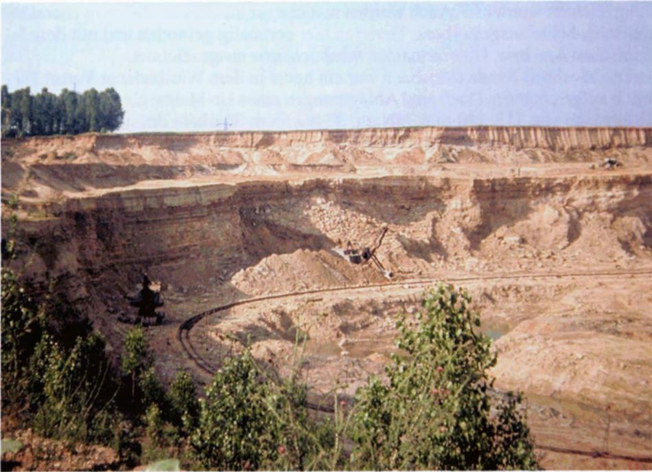
*Im Dyckerhoff-Steinbruch: unten die hellgelben Tertiärkalke, darüber die eiszeitlichen Mosbach-Sande in maximal 12 Meter Mächtigkeit*
