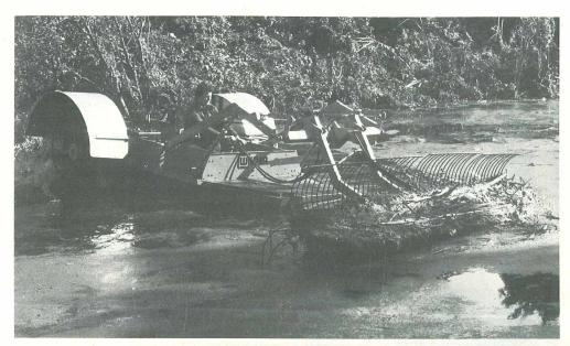
Das Fahrzeug hat 5,56 m Länge über alles und mit den Schaufelrädern eine Breite von 3,35 m. Werden die Schaufelräder zum Transport an Land oder zum Navigieren in engen Wasserstraßen hinter dem Fahrzeug angeordnet, so reduziert sich die Breite auf 2,21 m. Der Tiefgang beträgt 0,35 m, das Gewicht 1880 kg.
