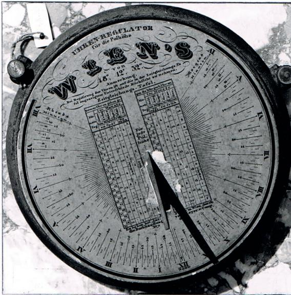
Abb. 32: Horizontalsonnenuhr für die Polhöhe von Wien (Nr. 33)
