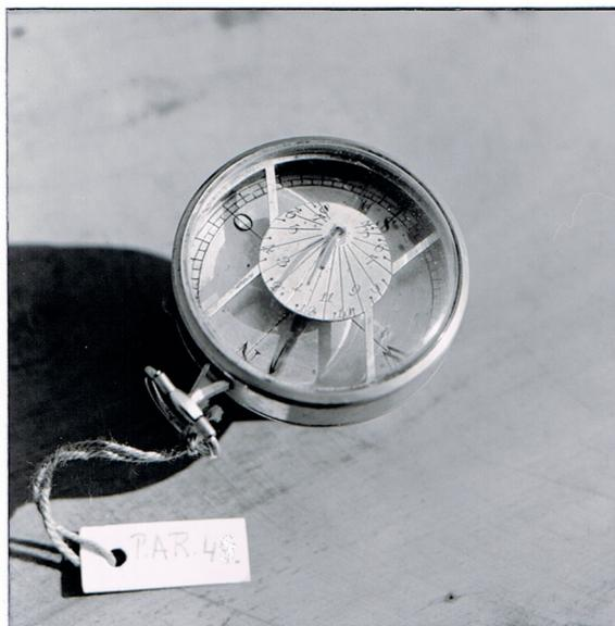
Abb. 43: Horizontalsonnenuhr in Taschenuhrformat Nr. 46
