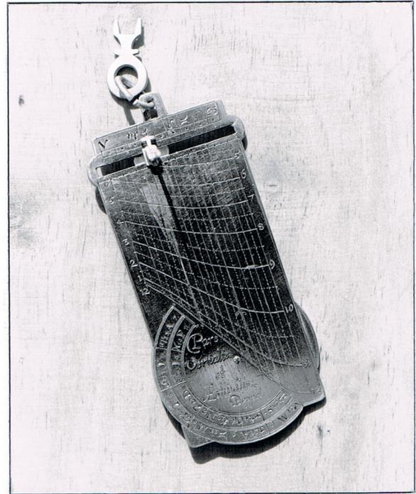
Abb. 72: Kleine Vertikalsonnenuhr mit Planetenkalender von Poppel mit Schlüssel, Nr. 76
