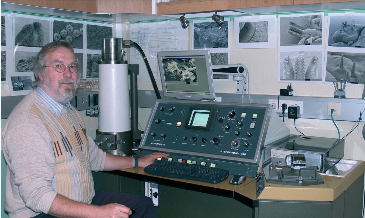
Abb. 1: Der Autor am Rasterelektronenmikroskop Stereoscan 600 mit PC-Erweiterung
