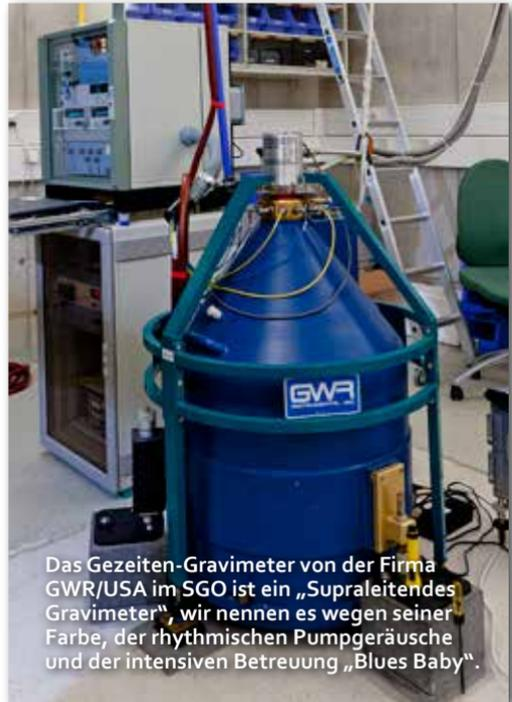
Das Gezeiten-Gravimeter von der Firma GWR/USA im SGO ist ein „Supraleitendes Gravimeter“, wir nennen es wegen seiner Farbe, der rhythmischen Pumpgeräusche und der intensiven Betreuung „Blues Baby“.
