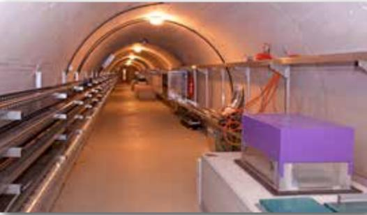
**Der 150 m lange Tunnel** im SGO mit verschiedenen Erdbeben-Mess-Systemen für Forschung und Entwicklung im Rahmen des österreichischen Erdbebendienstes. Der Blick in die violette Box zeigt die zentralen Seismometer im SGO, die gleichzeitig Teil des österreichischen Erdbebenmessnetzes sind.
