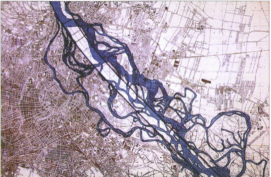
Abb. 1: Das ursprüngliche Furkationssystem der Donau bei Wien und das durch die Regulierung festgelegte Flussbett. – The original riverbed of the Danube in Vienna in comparison to the existing regulated river channel.
