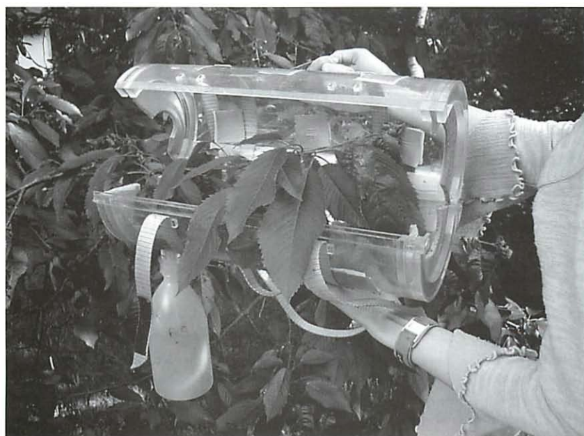
Abb. 2 Sammelrohr, zur Beprobung eines Zweiges aufgeklappt
