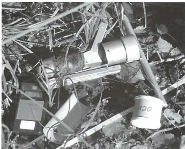
Bodenstecher zur Erfassung endogäisch lebender Bodentiere, z.B. Nematoda, Diplopoda, Chilopoda
